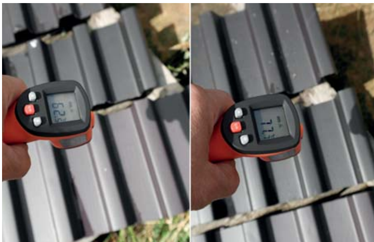
Měření povrchové teploty vzorků v měsíci září. Vlevo plech natřený barvou ETERNAL na kovy s obsahem Cool pigmentů, vpravo stejná nátěrová hmota v černém odstínu se standardními pigmenty.
