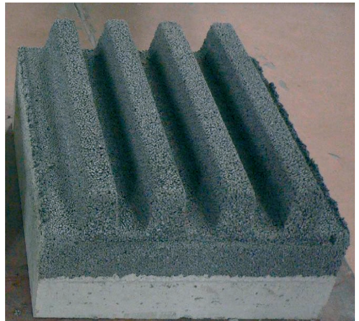
lehčený beton bez nátěru
