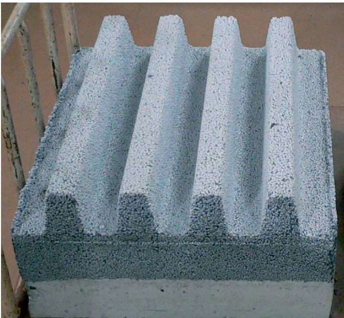
lehčený beton s nátěrem ETERNAL elast
