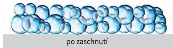
Odpařením vody při zasychání nátěru na sebe kuličky těsně dolehnou a vytvoří tak bariéru proti prostupu tepla.
